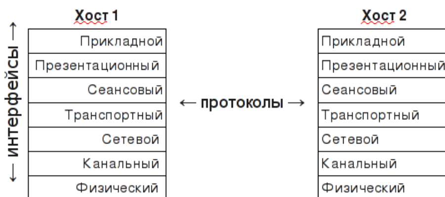
Рисунок 1.6 - Взаимодействие между уровнями OSI
