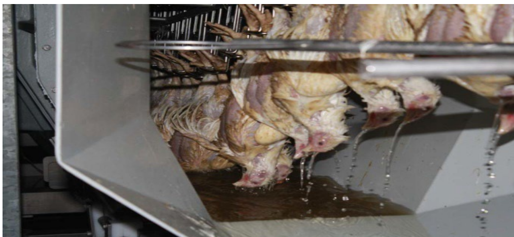
4-сурет - Құстарды электр тоғымен естен тандыру
