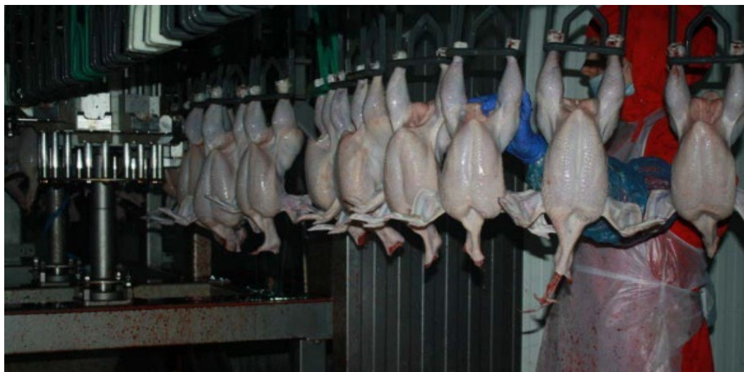
8-сурет - Құрсақ қуысының кесіліп, ашылуы және клоакасын (артқы тесігін) кесіп алу сәті
