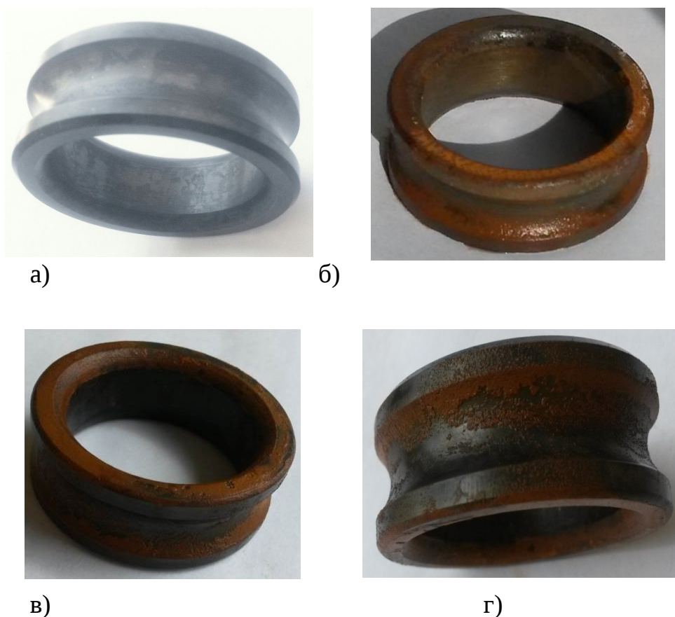
Рисунок 6.21 - Экспериментальные фотографии образца внутреннего кольца подшипника, обработанного методом МАО: а – до начала эксперимента, б – через 120 часов, в – через 192 часов, г – через 288 часов
