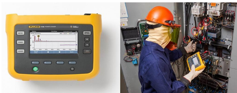
5.14 - сурет. Fluke электр энергиясының сапа анализаторлары өлшеу деректерін сымсыз жіберуге мүмкіндік береді
