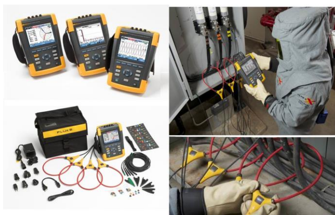
5.15 - сурет. Fluke 430 электр сапасының анализаторлары электр сапасының нашарлауына байланысты компания қанша ақша жоғалтатынын бірден көрсетеді
