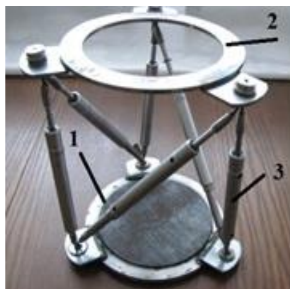
1a – SHOLKOR платформасы; 1b – Гоф-Стюарт платформасы
