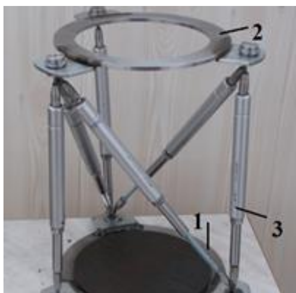
1a – SHOLKOR платформасы; 1b – Гоф-Стюарт платформасы
