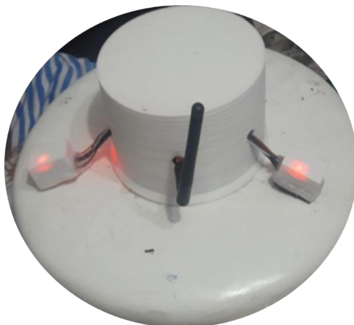
Сурет 4.2 – Өлшеу аппаратурасы бар қалтқы
