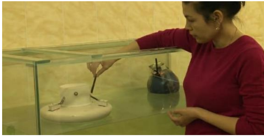
Сурет Д.3 – Қалқының үтіндегі сымсыз таратқыштан құралған өлшеу жүйесі
