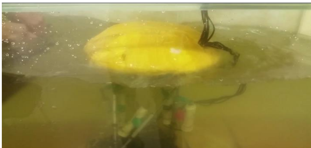
Сурет Б.1 – Аквариумдағы қалтқы және параллельді манипулятор
